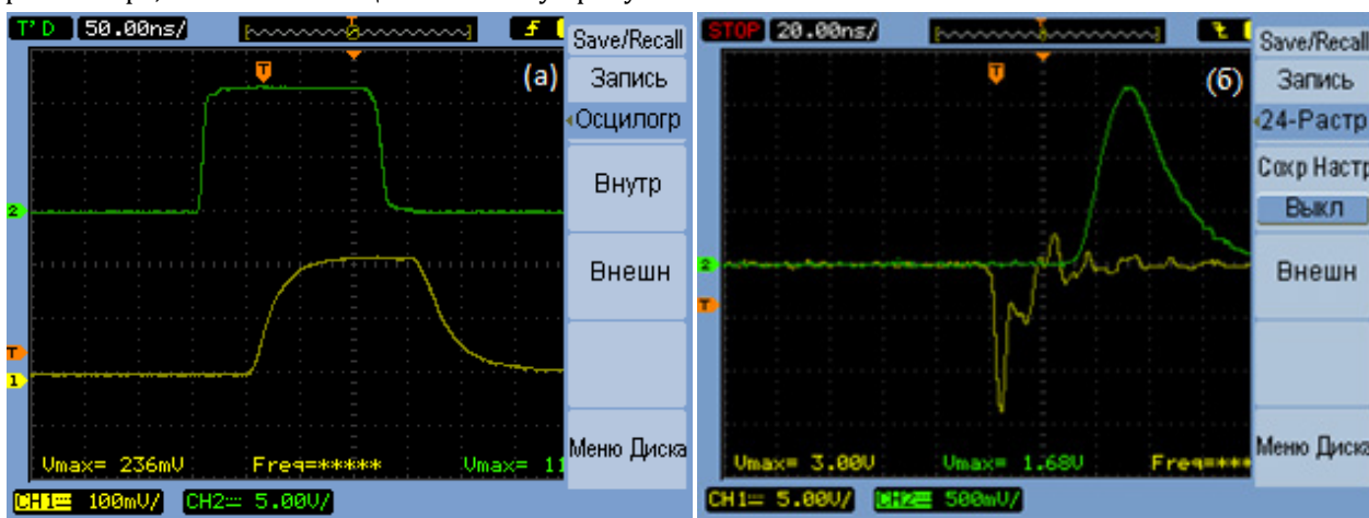
Рис. 2. Осциллограммы выходного импульса ФЭУ при засветке светодиодом в обычной схеме генератора (а) и в схеме с использованием транзистора в лавинном режиме (б). Первый по времени импульс — входной на светодиод, второй — выход ФЭУ. (Осциллограф 200 МГц).
