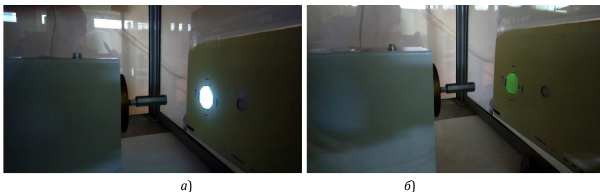
Рис. 6. Области засветки источников видимого (а) и рентгеновского (б) излучения на расстоянии анод-поверхность 7.5 см.
